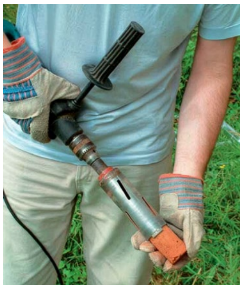
Afbeelding 5.2. Baksteenmonsters kunnen in-situ uit muurwerk worden geboord met behulp van een kernboor (Duller 2008).
