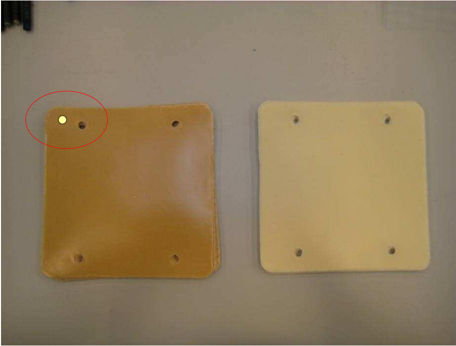
Links: Kationwisselend Membraan (CEM 11x) met extra gaatje Rechts: Anionwisselend Membraan (AEM 10x)
