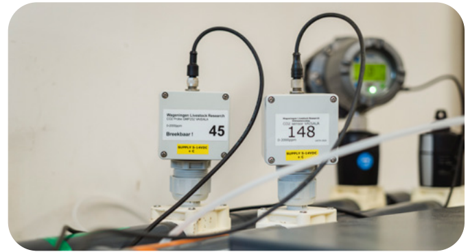
Meting van stalemissies (CO 2 , methaan, ammoniak).
